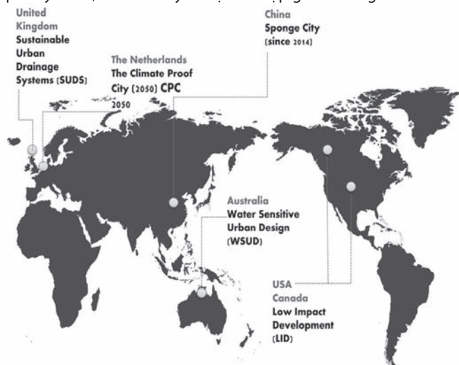
Hình 3. Các loại mô hình/giải pháp thoát nước ở các nước và mô hình Thành phố bọt biển tại Trung Quốc [5]
