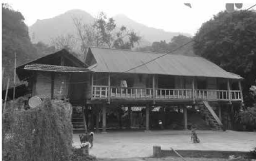
Hình 4. Hình ảnh ngôi nhà sàn dân tộc miền núi phía Bắc đã biến đổi nhưng vẫn giữ được kiến trúc truyền thống (vật liệu mái gianh đã thay thế bằng tấm tôn)
