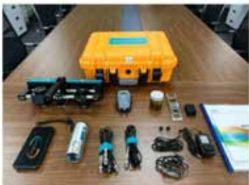
Hình 1. Máy đo chiều rộng và chiều sâu vết nứt bê tông F800
