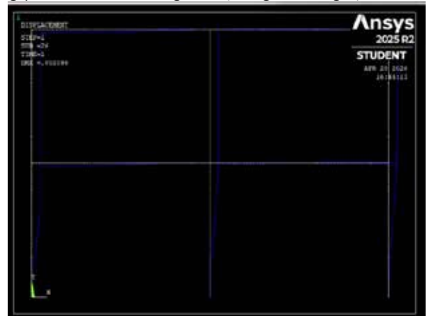
Hình 3. Sơ đồ biến dạng của khung khi phân tích ổn định phi tuyến bằng Ansys
