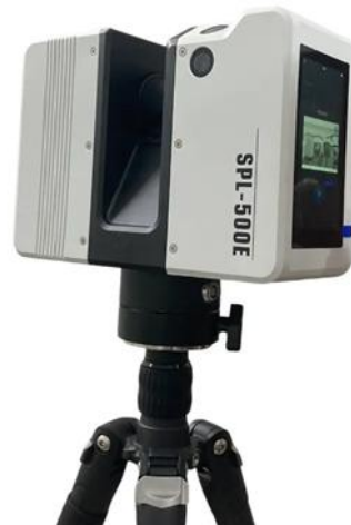
Hình 3: Hình và các thông số kỹ thuật chính của máy Scan Laser SPL-500E.
