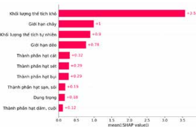
Hình 8. Mức độ ảnh hưởng của các thông số theo giá trị SHAP
