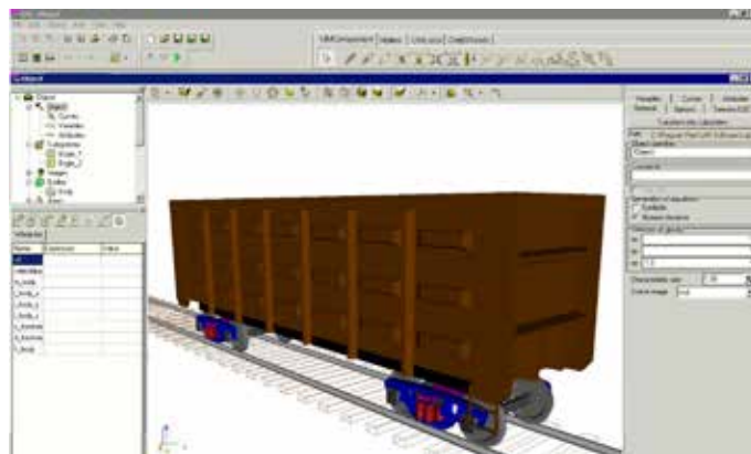
Hình 8. Mô hình 3D tính toán động lực học của toa xe hàng
