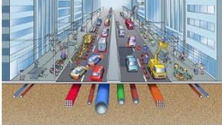
Các đường dây, đường ống kỹ thuật bố trí riêng rẽ dưới đường đô thị
